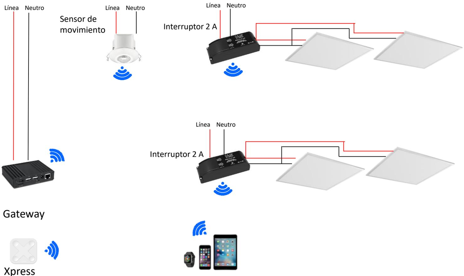
En este ejemplo se ilustra de una manera sencilla cómo interactúan los elementos en el sistema CASAMBI, donde se destaca su fácil instalación y configuración debido a que no requieren un cableado entre ellos ya su comunicación inalámbrica, el modelo Xpress funcionará de acuerdo a las características y configuración programada dentro del sistema CASAMBI.
